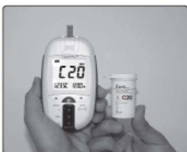
طمثمن شوید که کد روی جعبه نوار و کد نمایش داده شده روی دستگاه یکسان باشد کد نوار از روی برقسب رنگی پشت آن توسط دستگاه خوانده می‌شود
